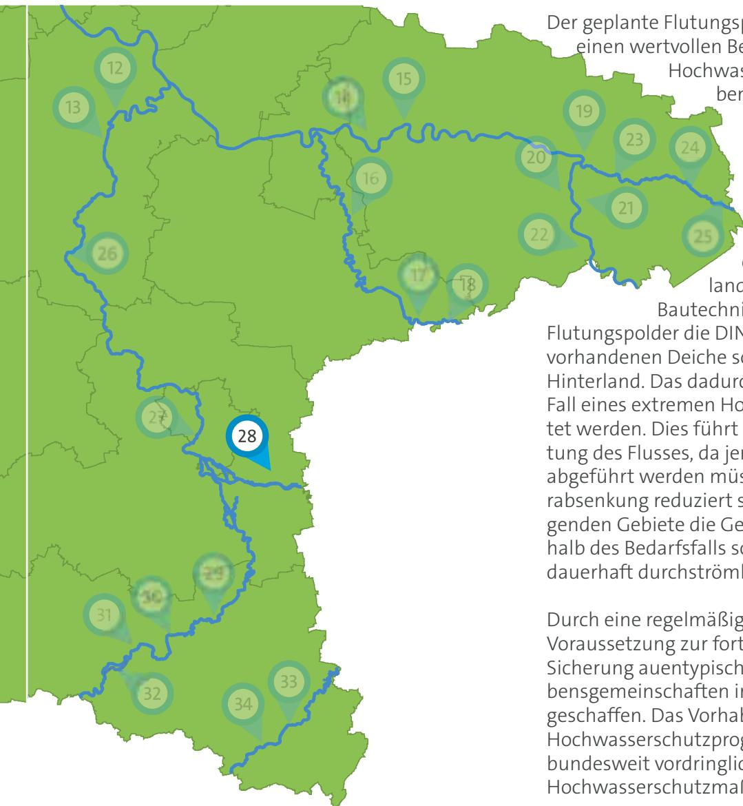
Der geplante Flutungspolder Elster-Luppe-Aue soll einen wertvollen Beitrag zum überregionalen Hochwasserschutz leisten. Das Vorhaben umfasst dazu eine Fläche von etwa 551 Hektar. Damit können etwa 12 Millionen Kubikmeter Wasser zurückgehalten werden. Die erforderliche Fläche besteht aus einem unbesiedelten Gebiet mit vorwiegend landwirtschaftlicher Nutzung.
